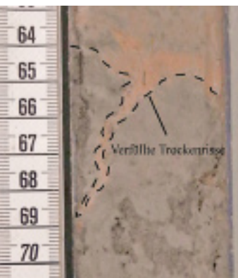
5 Ausschnitt aus dem Bohrkern B2. Die mit Sedimenten verfüllten Trockenrisse zwischen den gräulichen und rötlichen Schichten sind gut erkennbar.
