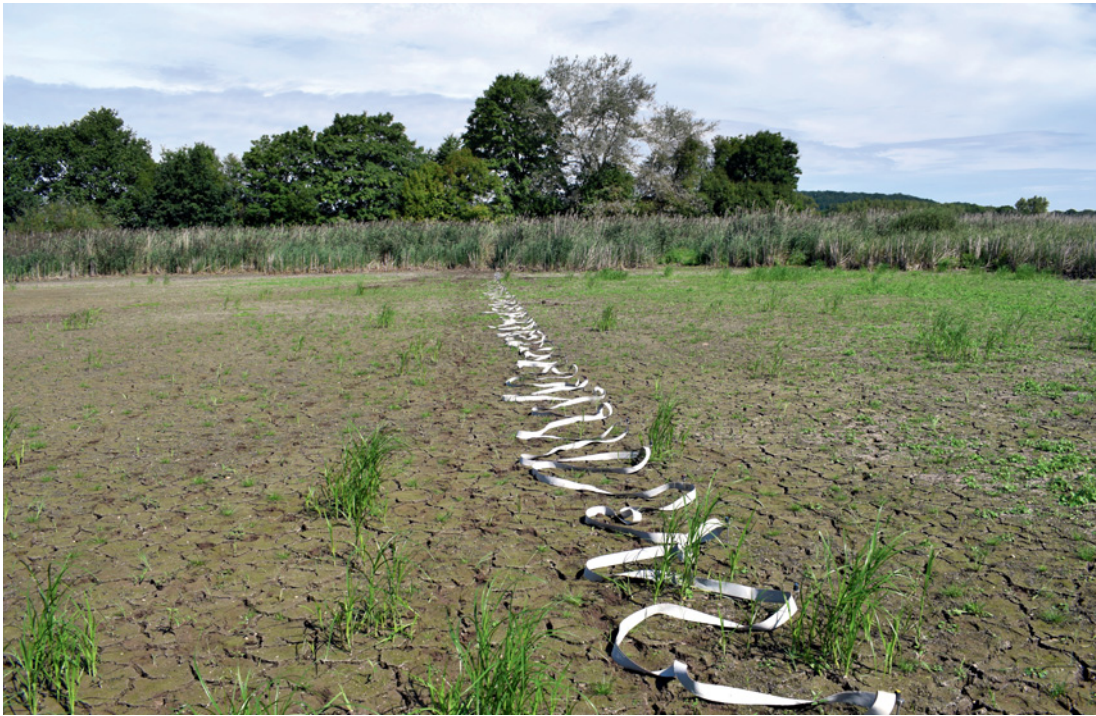
2 Verlauf der geoelektrischen Messstrecke ERT 5 im abgelassenen Teil des Rossweiher. Neben dieser Fläche schnitt die Strecke ebenso den nahen Schilfgürtel.
