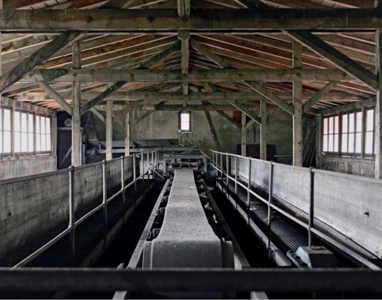
9 Blick von Osten in den Dachraum, wo der Koks über Laufband und Schütten auf die Kohlebunker verteilt wurde.
