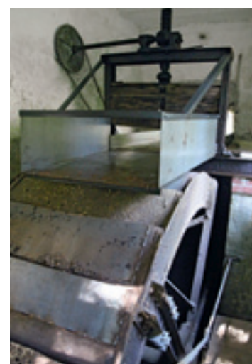
2 Liegende, doppelwirkende Kolbenpumpe mit Ledermanschette und Windkessel.
