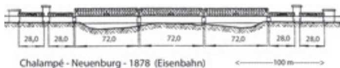
5–6 Eisenbahnbrücke Neuenburg–Eichwald 1878, Ansichtsschema und Südost-Ansicht 1930.
