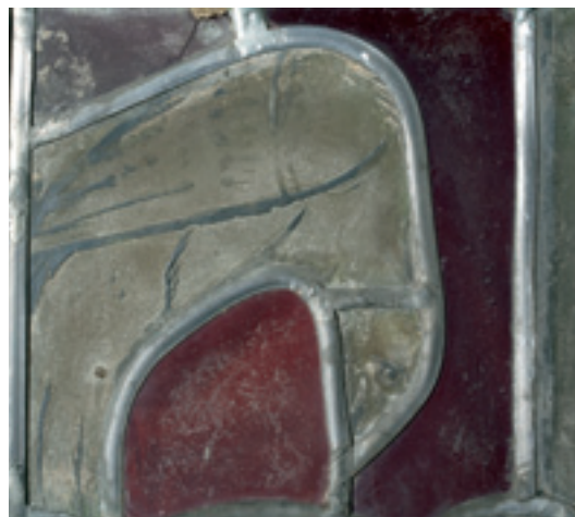
11 Detailaufnahme aus Feld nIII 2d, Pilotstudie des Fraunhofer-Instituts für Silicatforschung von 1992 mit Flächenfestigungen, hier zweifache Festigung mit Silicium-Zirkon-Alkoxiden (SZA), links Durchlicht, rechts Auflicht.
