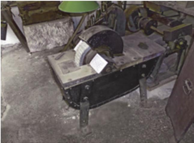
10 Das Foto zeigt einen Graveurtisch mit Kugelschleifrad.
