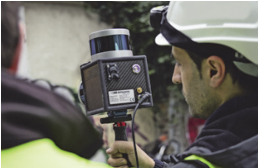
8 Einsatz des mobilen Laserscanners dotcube 600k.
