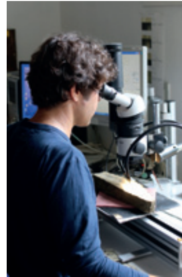
7 Linearmesstisch mit Binokular zur Messung der Jahrringbreiten. Auf dem Messtisch liegt das zu messende Holz.
