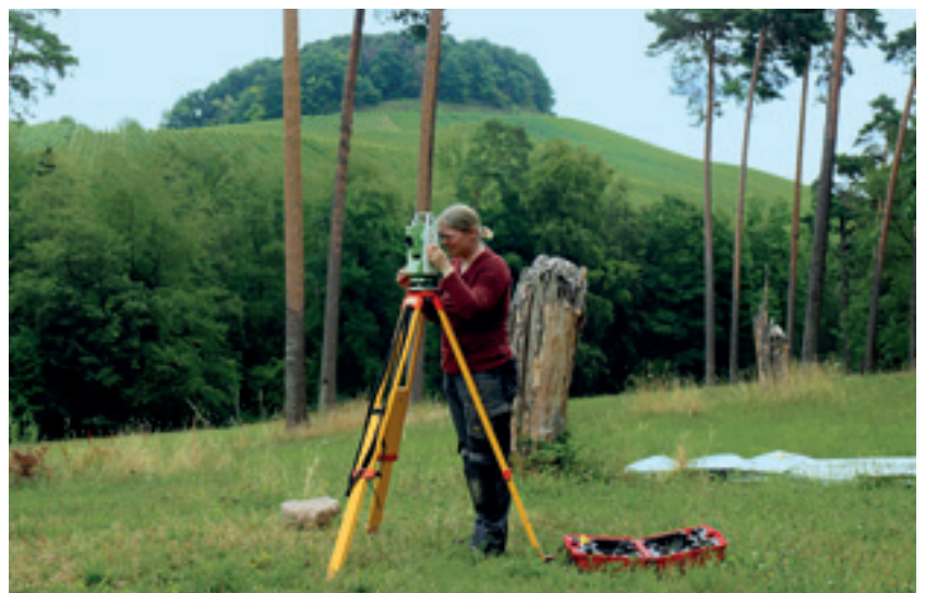
4 Eine Teilnehmerin beim Vermessen mit dem Tachymeter.
