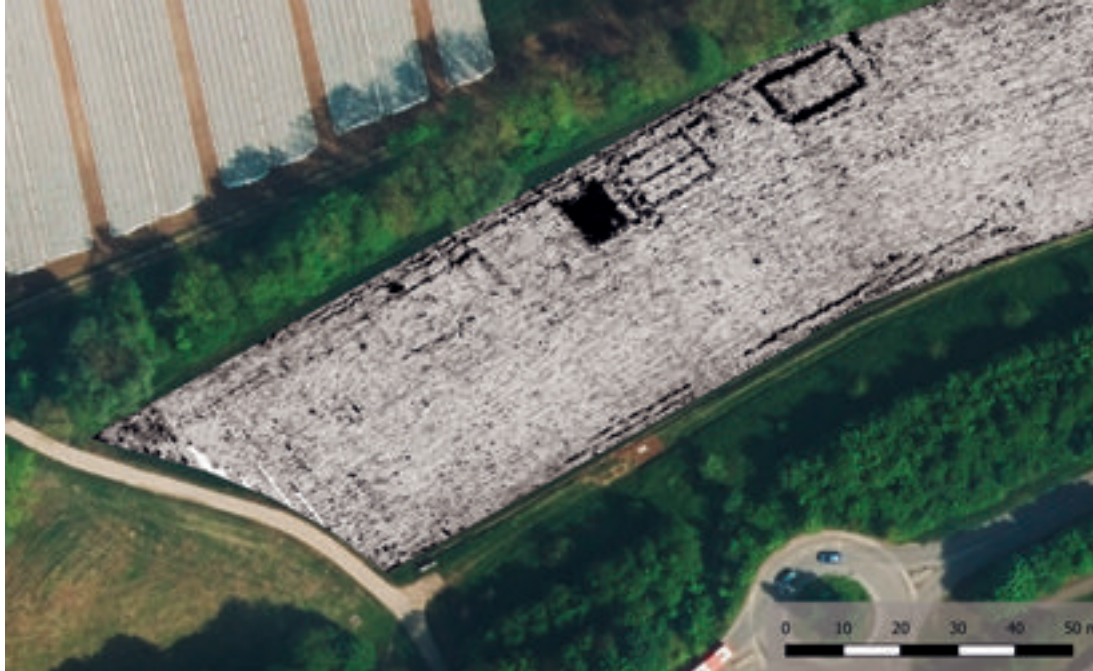
10 Bad Friedrichshall, Landkreis Heilbronn, Radargramm des ehemaligen KZ Kochendorf zeigt erhaltene Lagergebäude und den umfassenden Lagerzaun.
