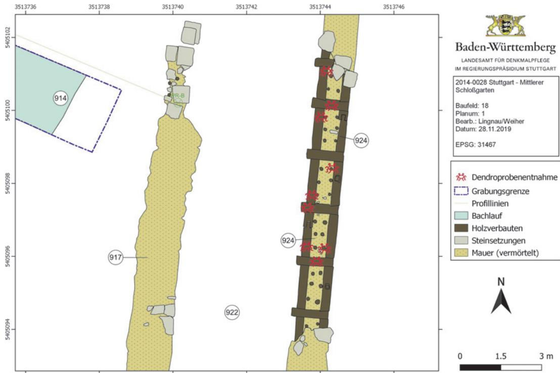
8 Plan des jüngeren Kanals zur Eindämmung des Nesenbachs aus der Mitte des 17. Jahrhunderts.
