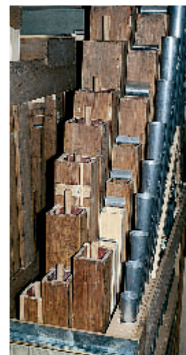
10 Historisches Pedalpfeifenwerk nach schreinerischer Reparatur. Auf größtmögliche Schonung der historischen Substanz wurde besonderer Wert gelegt.
