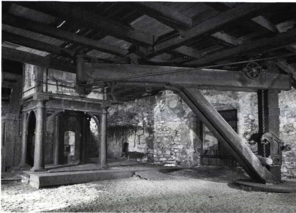
7 ALTE GIESSEREI, Königsbronn, hölzerner Drehkran aus dem 19. Jh. mit Laufkatze, Tragkraft 100 Ztr. Foto: Schwäbi- sche Hüttenwerke, Königs- bronn.
