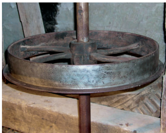
5 Ursprünglich blanke Stahloberfläche einer Transmissionsscheibe nach der Konservierung. Sie wurde im Niederdruckstrahlverfahren entrostet und mit OKS 2100 konserviert, einem Korrosionsschutzfilm auf Wachs-basis.
