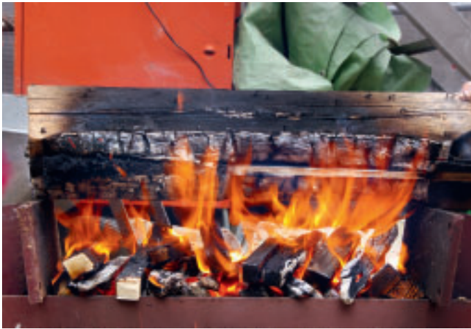
11 Prüfkörper nach 50-minütiger Beflammung von unten.
