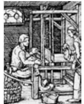
4 Wollweberei aus Italien (um 1420). Abbildung in der Handschrift des Humilatenordens. Dargestellt sind die wichtigsten Geräte: ein Trittwebstuhl mit sechs Schäften, ein Schär Rahmen mit einem Tisch mit zwölf Garnspulen und ein Spulrad mit Haspel. So konnten Gewebe in Tuchbindung und in verschiedenen Körperbindungen gewebt werden, zum Beispiel Spitzkaro (oben).
