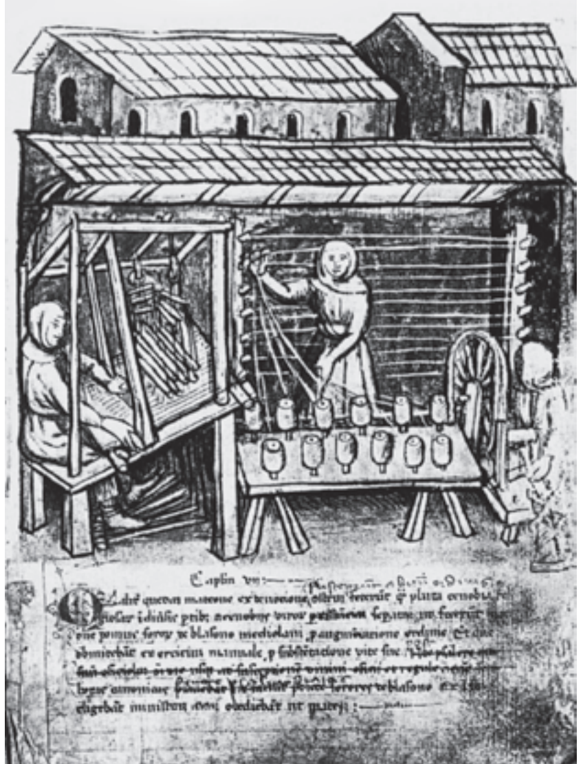
4 Wollweberei aus Italien (um 1420). Abbildung in der Handschrift des Humilatenordens. Dargestellt sind die wichtigsten Geräte: ein Trittwebstuhl mit sechs Schäften, ein Schär Rahmen mit einem Tisch mit zwölf Garnspulen und ein Spulrad mit Haspel. So konnten Gewebe in Tuchbindung und in verschiedenen Körperbindungen gewebt werden, zum Beispiel Spitzkaro (oben).
