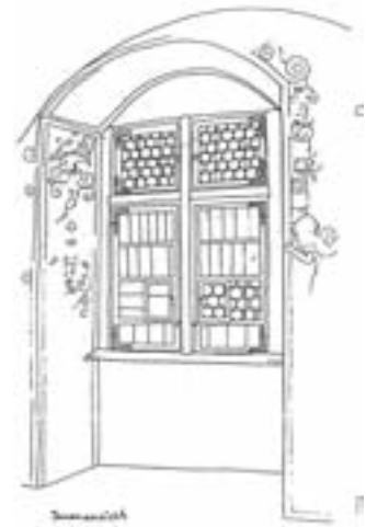
3 Fenster 007, verformungsgerechtes Handaufmaß des bauzeitlichen Fensters.
