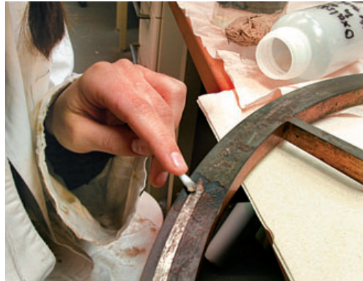
4 Reinigung des Silberlimbus am Vertikalkreis.
