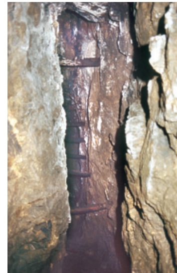
6 Abbau I mit alten Holzstempeln.
