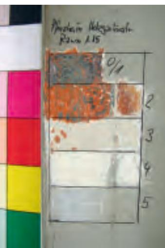
Gerade bei Stahlfenstern kommt der Qualität der Anstriche eine große Bedeutung zu, da sie gerne in industriell und gewerblich intensiv genutzten Räumen und Anlagen eingesetzt werden und einer erhöhten mechanischen und physikalischen Beanspruchung unterliegen. Ähnlich wie bei Holzfenstern wurden ab den frühen 1950er Jahren die Leinöl- und Standölfarben durch synthetische Farben auf Basis von Kunstharzen verdrängt (Abb. 16).
