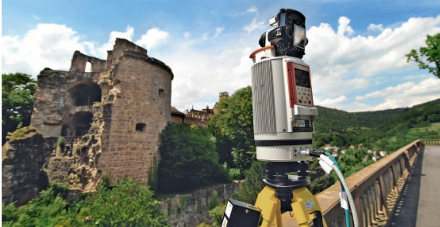
Fragestellungen können auch Parallelprojektionen berechnet werden, um an der abgerollten Mauer- oberfläche genaue Maße abnehmen zu können. Da dabei noch immer die dreidimensionale Infor- mation zur Verfügung steht, kann zum Beispiel die Abweichung des Bauwerks vom idealen Zylinder exakt bestimmt werden (Abb. 7). Dadurch werden bereits Details wie Bewuchs und Mauerfugen deutlich erkenn- und messbar.
