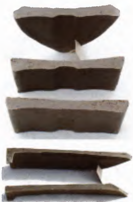
16 Schnitte und Seitenansichten von Rohlingen der Reparaturziegel.
