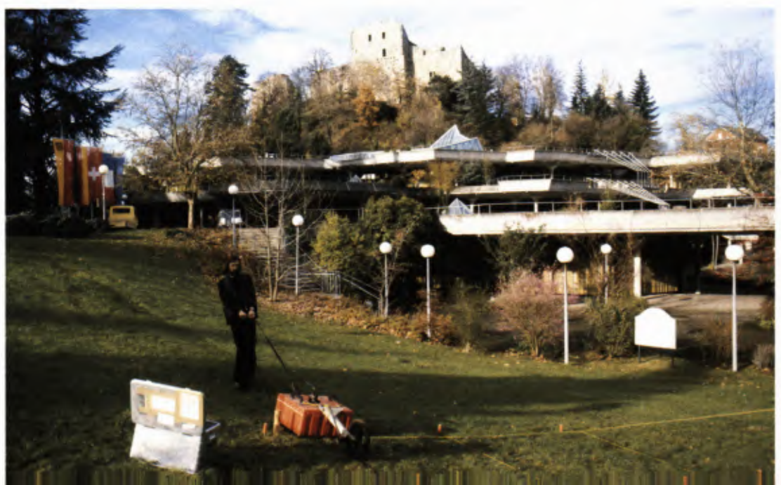
1 Das Bodenradarsystem im Einsatz. Ein Mitarbeiter des LDA mit der 200-MHz-Antenne bei der Messung vor dem Kurhaus in Badenweiler.
