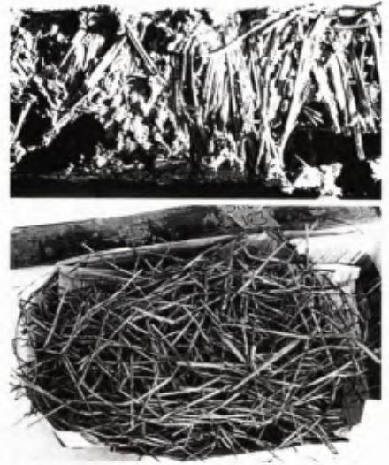
■ 2 Oben: Wellerholz des 18. Jh. aus einer Decke in Schwäbisch Hall, Pfarrgasse 9; eine Latte war mit Langstroh und Lehm umwickelt. Unten: Das Wellerholz in seine pflanzlichen Bestandteile aufgelöst.
