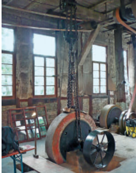
4 Innenraumansicht mit großen, wassergetriebenen Schleifsteinen der Werkzeugschleiferei. Ursprünglich wurde auf diesen Steinen Eisenwerkzeug vorgeschliffen.
