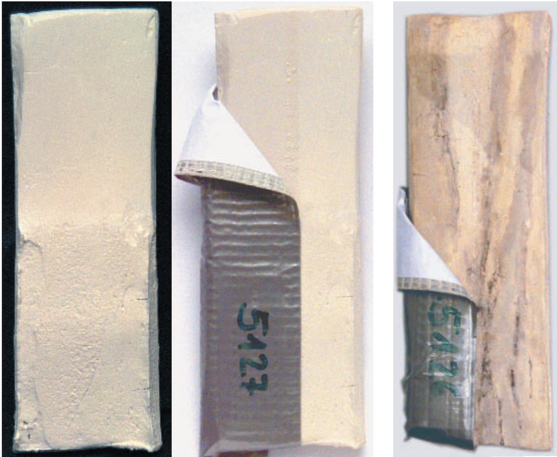
4 Der Kittmörtel der Rezeptur FM1 vor (links) und nach (rechts) der UV-Bestrahlung. Es traten keinerlei Schäden auf (links mit UV-undurchlässiger Folie abgeklebt).
