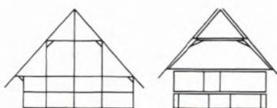
Abb. 142 Links: Stehender Stuhl mit bis zum Boden durchgehenden Ständern Rechts: Liegender Stuhl, kistenweiser Abbundung
