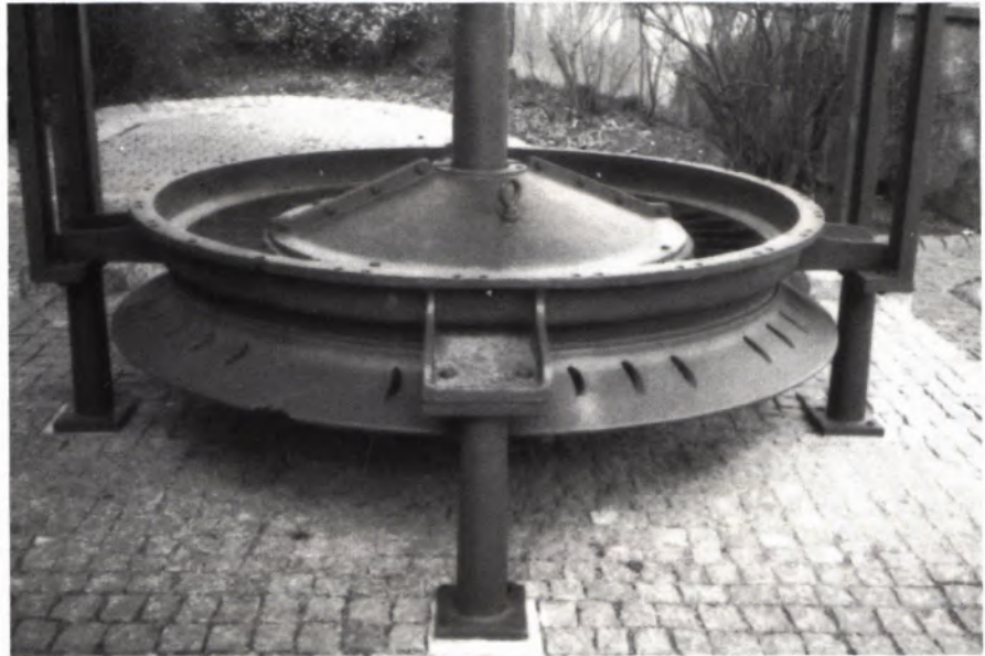
10 GIRARDTURBINE in Stautfen i.Br. Oben Leitrad, unten Lauf- rad. Deutlich sind die D-förmigen Öffnungen zur Belüftung der Rad- zellen des Laufrades zu erkennen.
