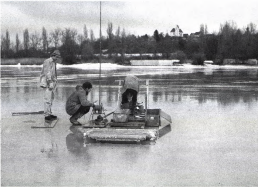
17 ABBOHREN eines Sedimentprofils vom Eis des Bodensees vor Hornstaad.
