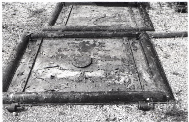
21 KESSELTÜREN mit dem Firmenschild des Herstellers, ebenfalls für das Landesmuseum für Technik und Arbeit vorgesehen, liegen Wind und Wetter ausgesetzt auf dem Gelände des Bauhofs.
