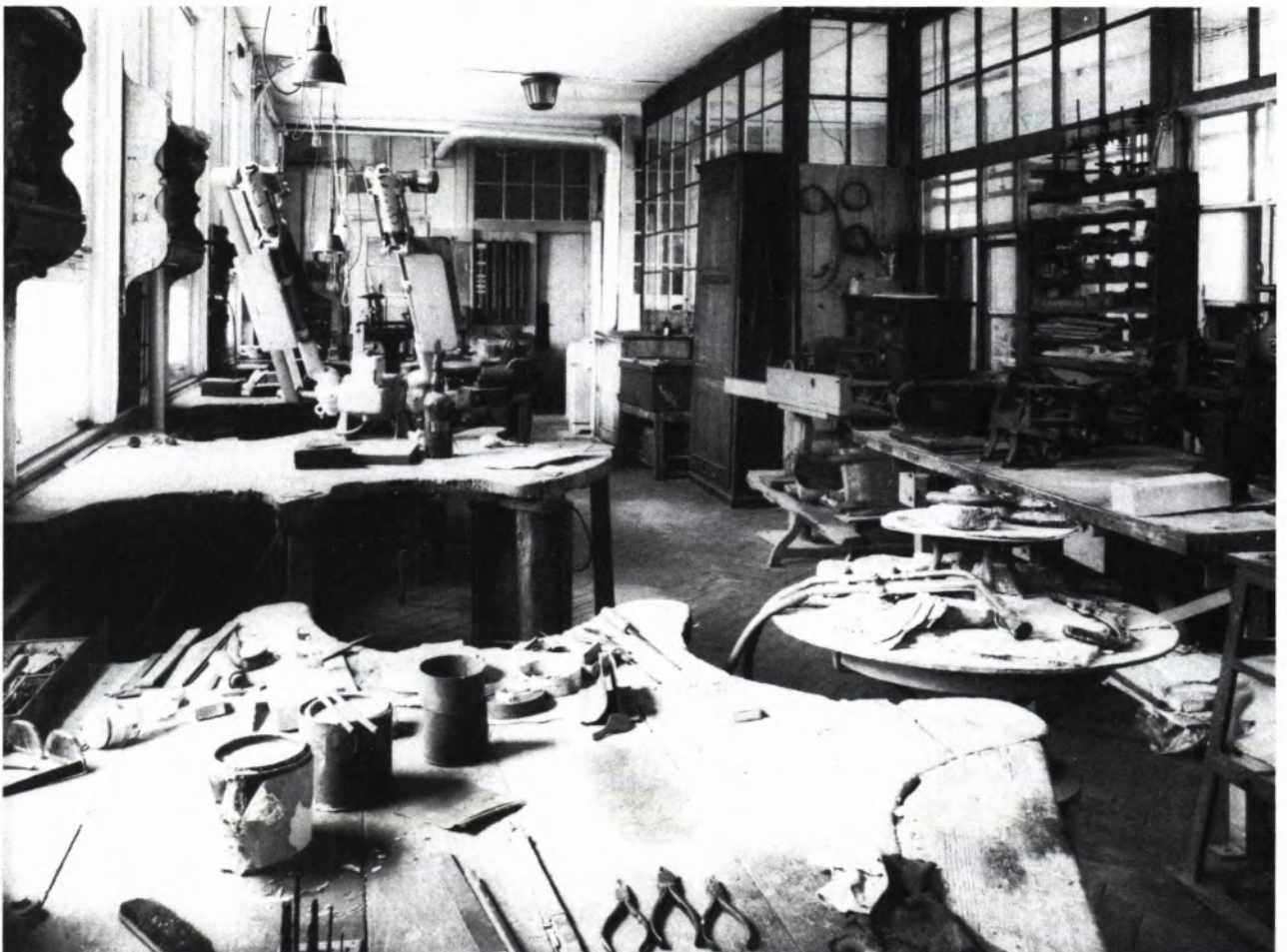
8 SCHWÄBISCH GMÜND, OTT-PAUSERSCHE SILBERWARENFABRIK. Blick in den Werkraum des Obergeschosses mit der vollständig erhaltenen Ausstattung (Foto 1985). Die Arbeitsplätze besitzen halbrunde Aussparungen, damit die Metallabfälle leichter in die große Tasche vor der Arbeitsschürze eines jeden Arbeiters gelangen konnten.
