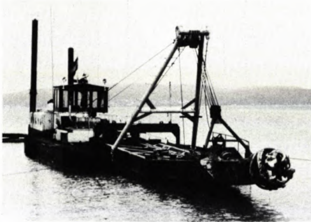
5 SAUGBAGGER in einer Ufersiedlung bei Litzelstetten 1975. Mit dem absenkbaren Turbinenkopf wird der Seegrund aufgewühlt und über Leitungen ins tiefere Wasser abgesaugt; dabei gelangt kein einziges Fundstück in die Hand des Archäologen.
