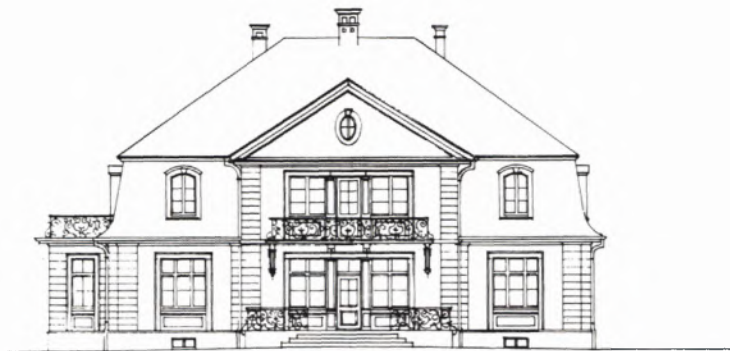
6 GARTENANSICHT. Auch hier wie bei der Hauptansicht die Betonung der Mitte durch einen Risalit mit Stirngiebel, dazu Terrasse, Balkon und Seitenanbau mit reichen schmiedeeisernen Brüstungsgittern.
