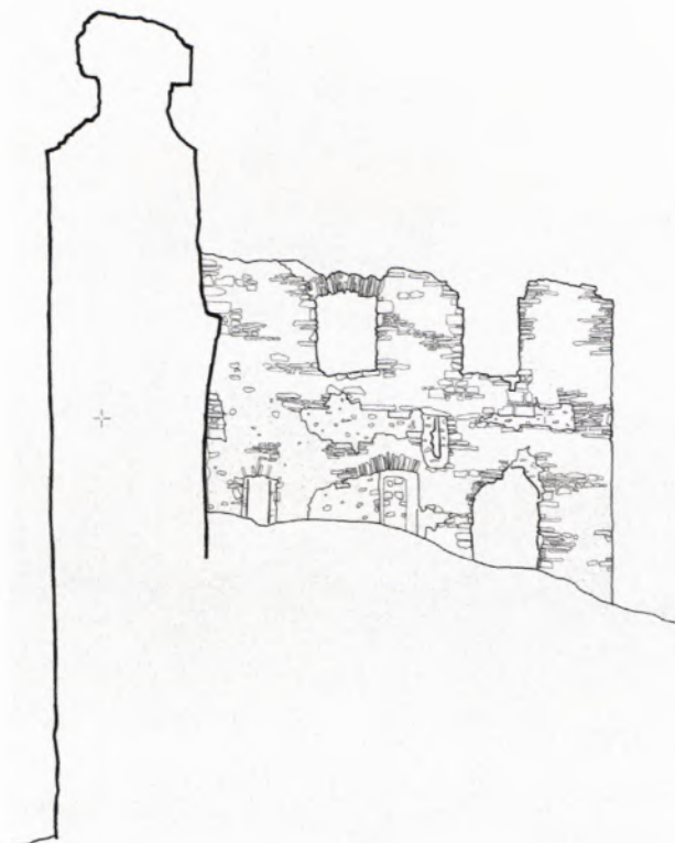
11 ZUZENHAUSEN, photogrammetrisch gezeichnete Ansicht der Gebäudewand mit Schnitt durch die Schildmauer. Wasser dringt durch die Mauerkrone ein, und bei Frost- und Tauwechsel werden in den Wintermonaten Steine aus dem Mauergefüge herausgesprengt. Durch die exakte photogrammetrische Vermessung wird das Ausmaß der Schäden, insbesondere im oberen Teil der Schildmauer, aufgezeigt.
