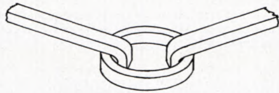
3 FREIBURGER MÜNSTER, Hahnentürme. Verbindung der eisernen Zuganker.
