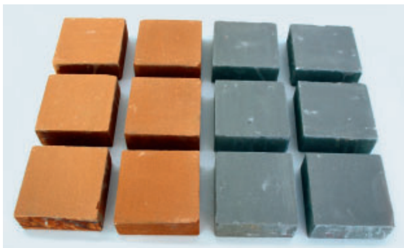
13 Versuche mit Schutzschlämmen für den Eisensandstein und Molassesandstein 2012.
