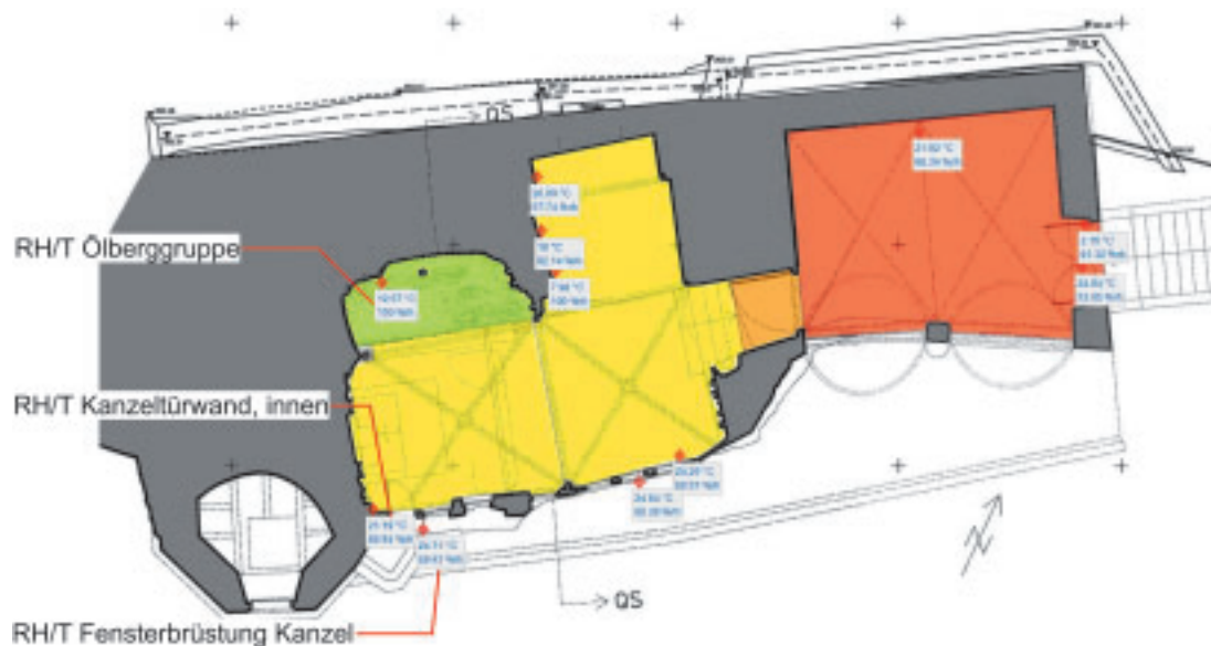
7 Darstellung der Sensorpositionen zur Messung der Klimadaten im Bereich der oberen Kapelle (Auszug der webbasierten Online-Visualisierung mit Sensorpositionen und aktuellen Messwerten am Objekt).
