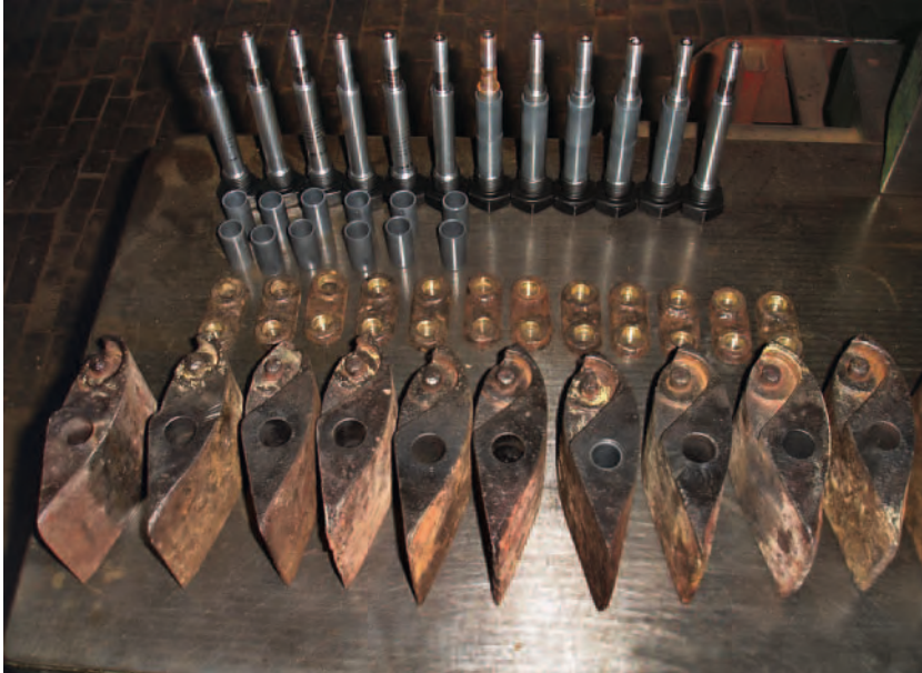
7 Neu angefertigte Achsbolzen, gereinigte Stellhebel und Leitschaufeln.
