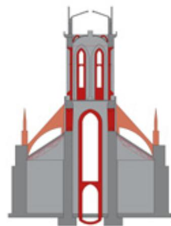
11 Schematische Darstellung der Ausbauphase im 19. Jahrhundert: Strebe- und Verstärkungsmaßnahmen für den Turmausbau 1856–1873 (hellrot) und Verstärkungsmaßnahmen für den Turmausbau 1882–1885 (dunkelrot).
