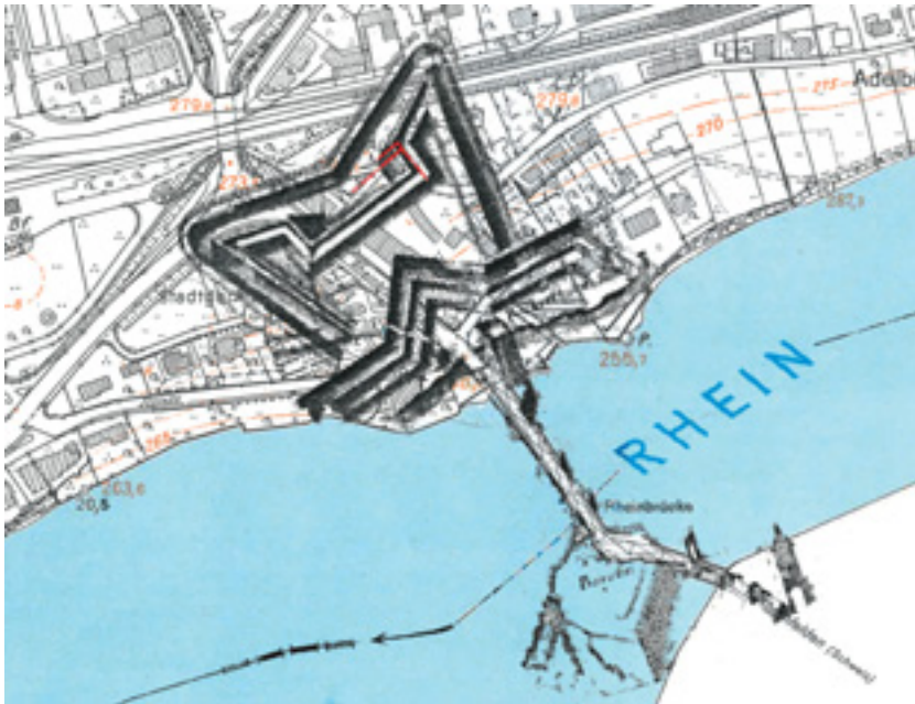
1 Lage und Ausdehnung des rechtsrheinischen Brückenkopfes von Rheinfelden konnten durch archäologische Befunde (rot) exakt lokalisiert werden.
