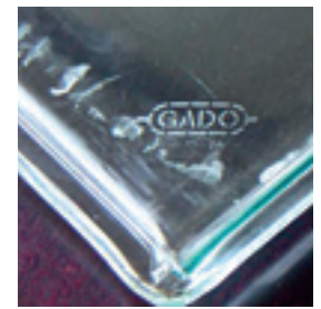
2 Isolierglas „CUDO“ von 1968 mit geklebtem Randverbund (l. o.).
