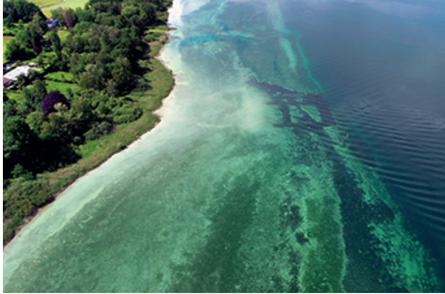
8 Drohnenaufnahme der Flachwasserzone vor Litzelstetten 2020. Man erkennt gut die eingebrachten Schutzschüttungen (vgl. Abb. 3).
