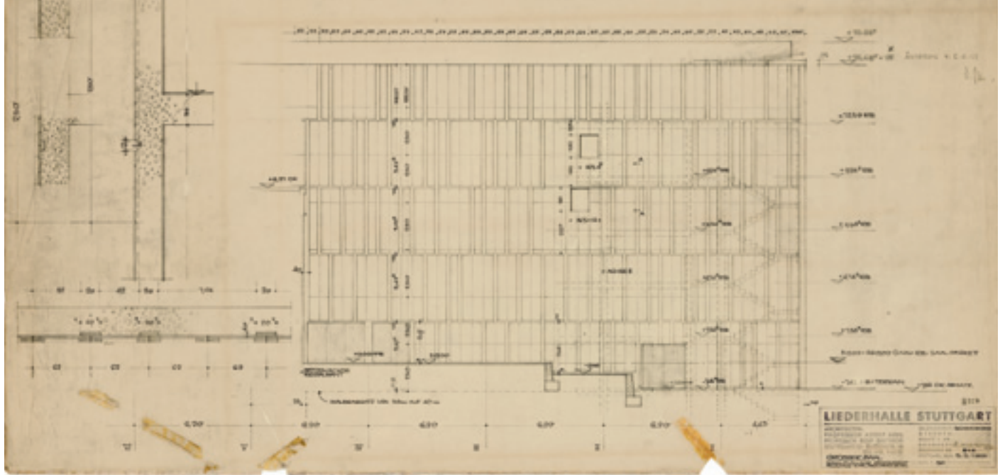
7 Schalplan der Außenwand in Richtung Schlossstraße.
