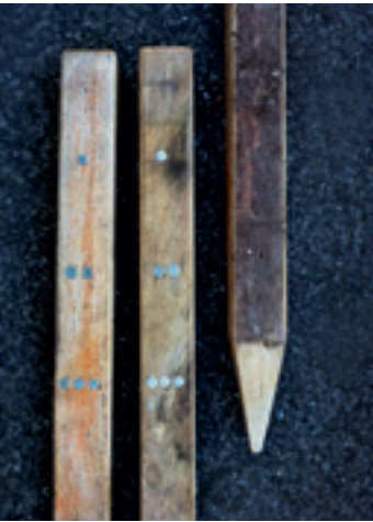
4 Klassische Erosionsmarker: Eichenpflocke mit Markierungen, an denen die Erosion/Akkumulation abgelesen wird.
