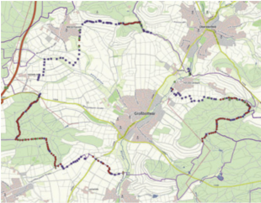
10 Darstellung aller Grenzsteine der Gemarkung Großbottwar erstellt mit QGIS. Rote Punkte: In der figurierten Grenzbeschreibung beschriebene und auch im Gelände aufgefundene Steine. Grüne Punkte: Im Gelände vorhandene Steine, jedoch nicht in der figurierten Grenzbeschreibung erwähnte Steine, da sie nach 1731 neu gesetzt wurden. Stern: Nicht mehr vorhandene Steine. Gelber Pfeil: Grenzsteine, die nicht mehr am ursprünglichen Ort stehen.
