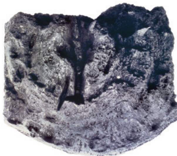
2 Stark angewittertes Ende eines eichenen Balkens. Dieser muss nach der Bergung gesägt und präpariert werden, um die Jahrringe messen zu können.
