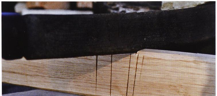
Abb. 7 Hiebspuren eines modernen Buschmessers auf der nachgefertigten Klinge des Holzschwertes Nr. 10. Eindringtiefe auf dem Rücken 6 mm und auf der Breitseite 3 mm. (Foto: Verfasser).
