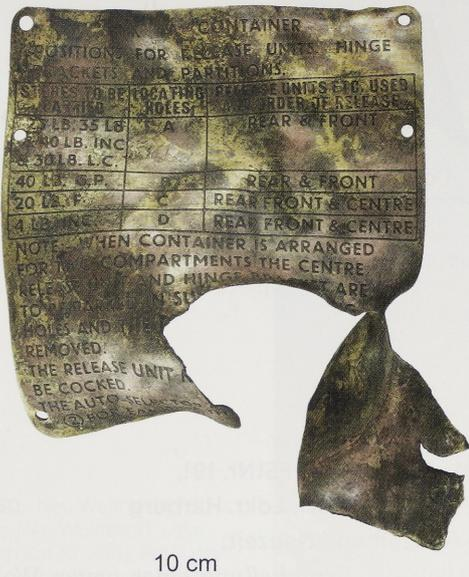
**Abb. 145** Jesteburg FStNr. 86, Gde. Jesteburg, Ldkr. Harburg (Kat.Nr. 202). Beladungshinweisschild eines Bombencontainers Mk. 1A für Stabbrand- oder Phosphorbomben. M. 1:2. (Foto: T. Weise)
