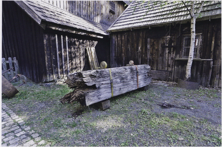
Abb. 82 St. Andreasberg FStNr. 34, Gde. Stadt Braunlage, Ldkr. Goslar (Kat.Nr. 123). Die erhaltene Welle des 1924 ausgebauten Kunstrades. (Foto: J. Meyer)
