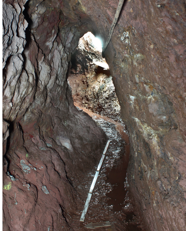
Abb. 94 Clausthal FStNr. 150, Gde. Berg- und Universitätsstadt Clausthal-Zellerfeld, Ldkr. Goslar (Kat.Nr. 132). Nach dem Abbau des Tretwerkes freigelegtes, in die Sohle gehauenes Gerenne. (Foto: G. Drechsler)
