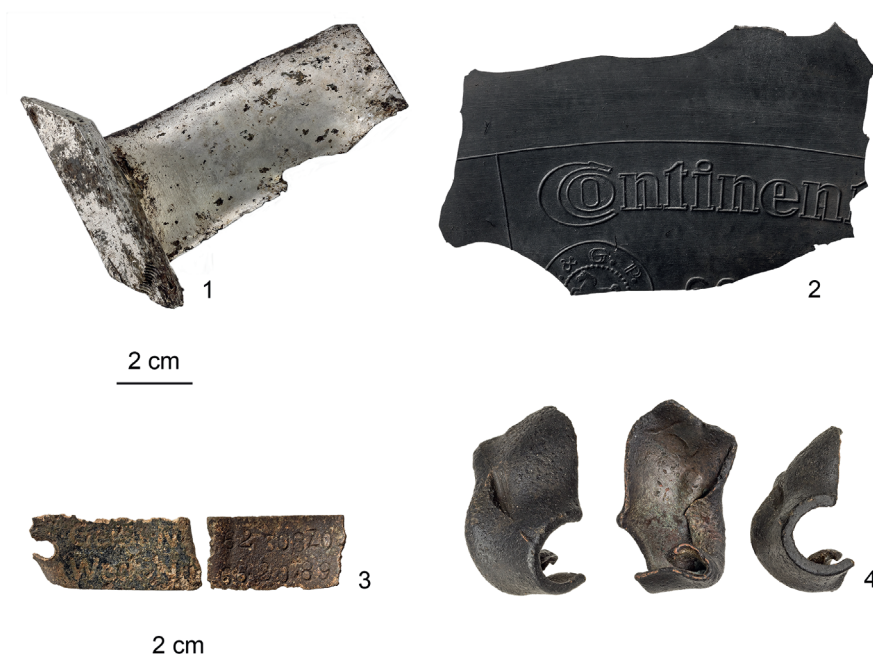
Abb. 160 Insel FStNr. 53, Gde. Stadt Schneverdingen, Ldkr. Heidekreis (Kat.Nr. 234). 1 Eine Laufschaufel aus einem der zwei Jumo 004-Triebwerke, 2 „Continental“-Logo des Bugreifen- schlauches der Maschine, 3 Typenschild aus dem hinteren Rumpfbereich des Flugzeuges, 4 Stark deformierter Projektilmantelrest eines 12,7 mm- Geschosses. 1–2 M. 1:2; 3–4 M. 1:1. (Fotos: T. Weise)
