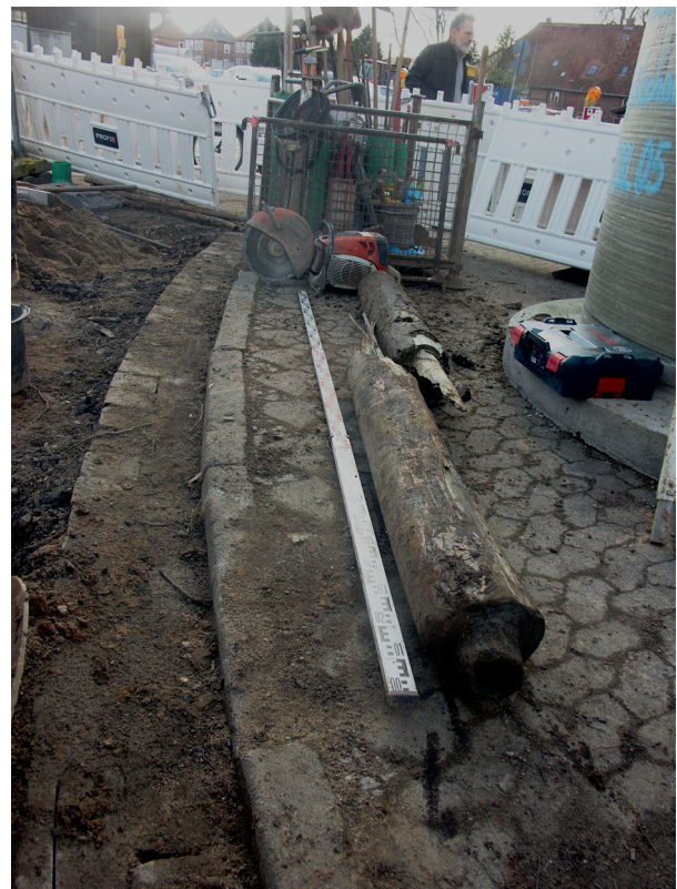
Abb. 267 Gadenstedt FStNr. 146, Gde. Ilsede, Ldkr. Peine (Kat.Nr. 374). Die in der Mitte gerissene neuzeitliche Pipenleitung nach der Bergung. (Foto: T. Budde)
