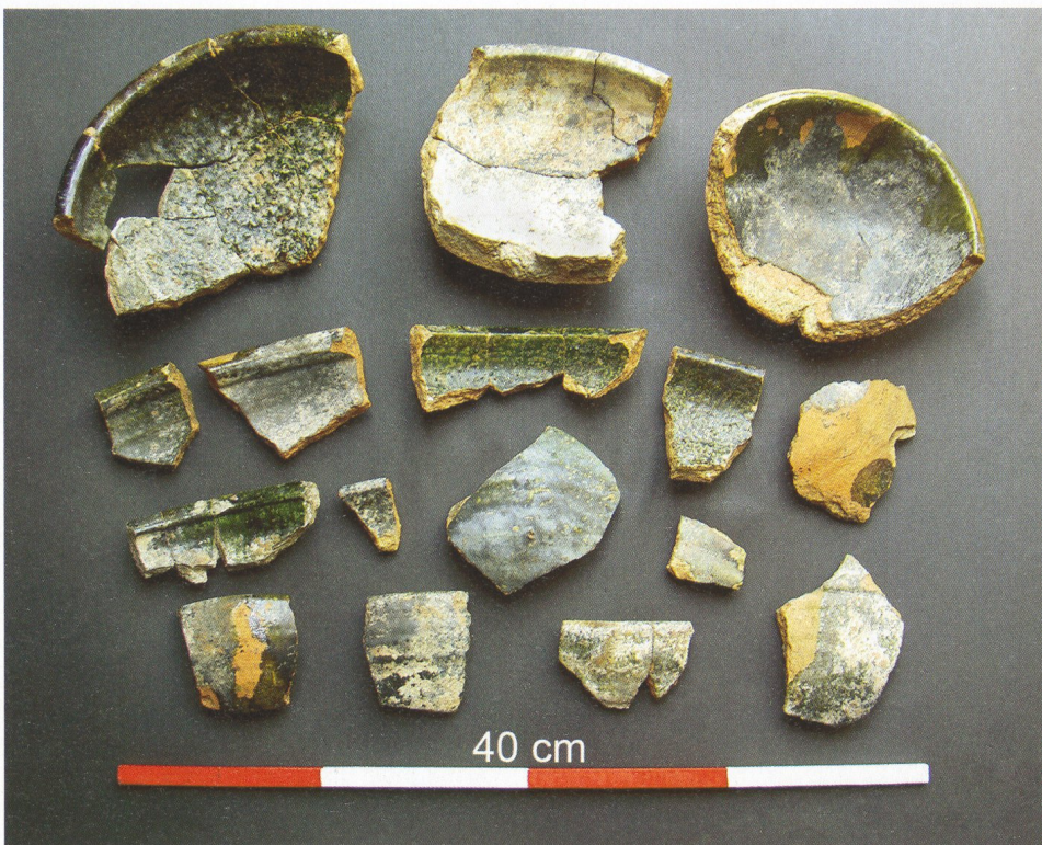
Abb.184F Peine FStNr. 129, Gde. Stadt Peine, Ldkr. Peine (Kat. Nr. 221). Fragmente von Schmelztiegeln zur Herstellung von Bleiglasuren, gefunden in der Sohle der Feuerungsanlage Schützenstraße 1 (14. Jh.). (Foto: T. Budde)
