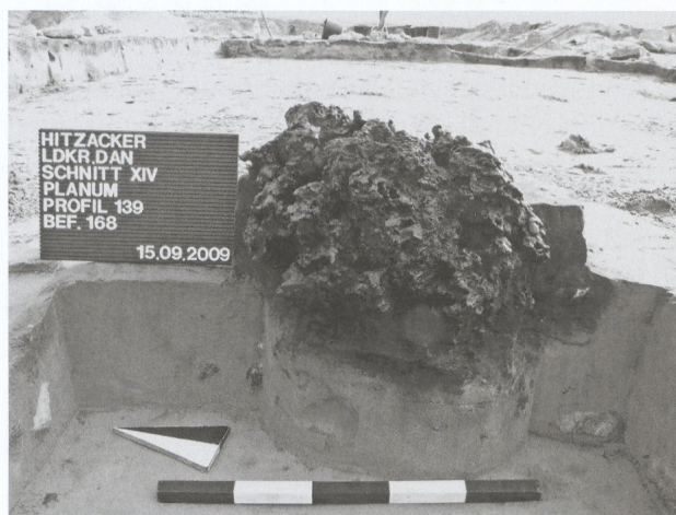
Abb. 137 Hitzacker FStNr. 43, Gde. Stadt Hitzacker, Ldkr. Lüchow-Dannenberg, (Kat.Nr. 209) Befund 168, Schlackenklotz in einer Schlackengrube. (Foto: Georg-August-Universität Göttingen)
