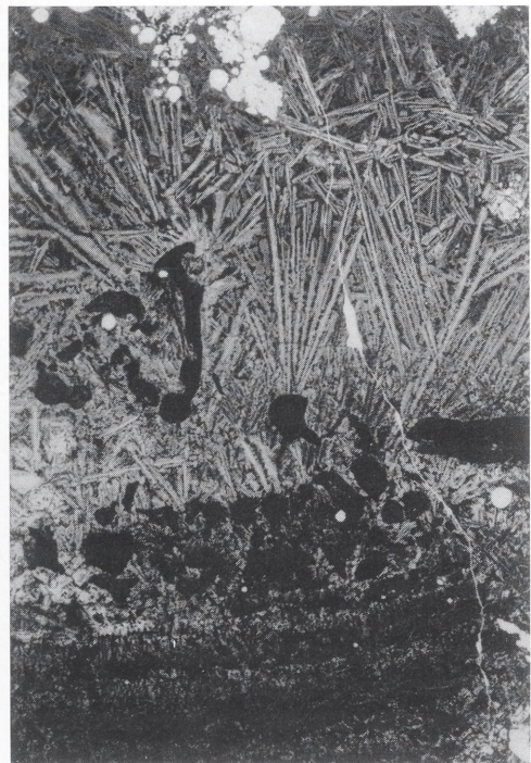
Abb. 8 Nörten-Hardenberg, Ldkr. Northeim. „Steinbühl“. Probe Nr. 24—8, Präparat Nr. 1289 A. Fayalitreiche dichte Schlacke mit lagenweiser Anhäufung von Eisenoxiden (dunkel). Polierter Dünnschliff, Durchlicht, 1 Polarisator. Maßstab = 1 cm.
